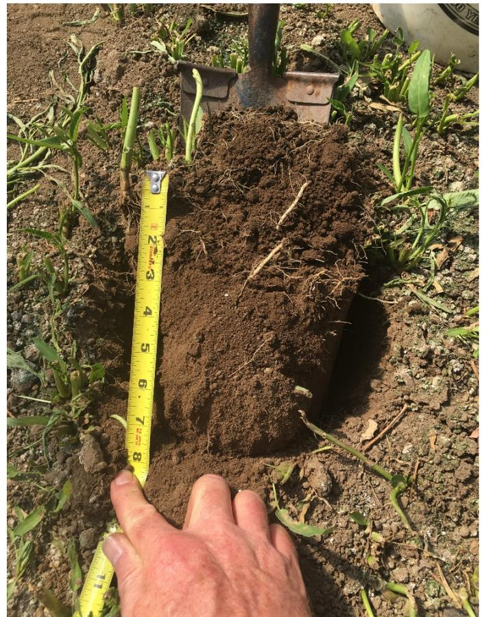
Imagen 3. Un hoyo de forma V con una profundidad de aproximadamente 8 pulgadas y una sección de suelo de un lado del hoyo. Foto por Drew Mather.
